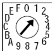
Рисунок 2.5 Установка адреса системной стойки
