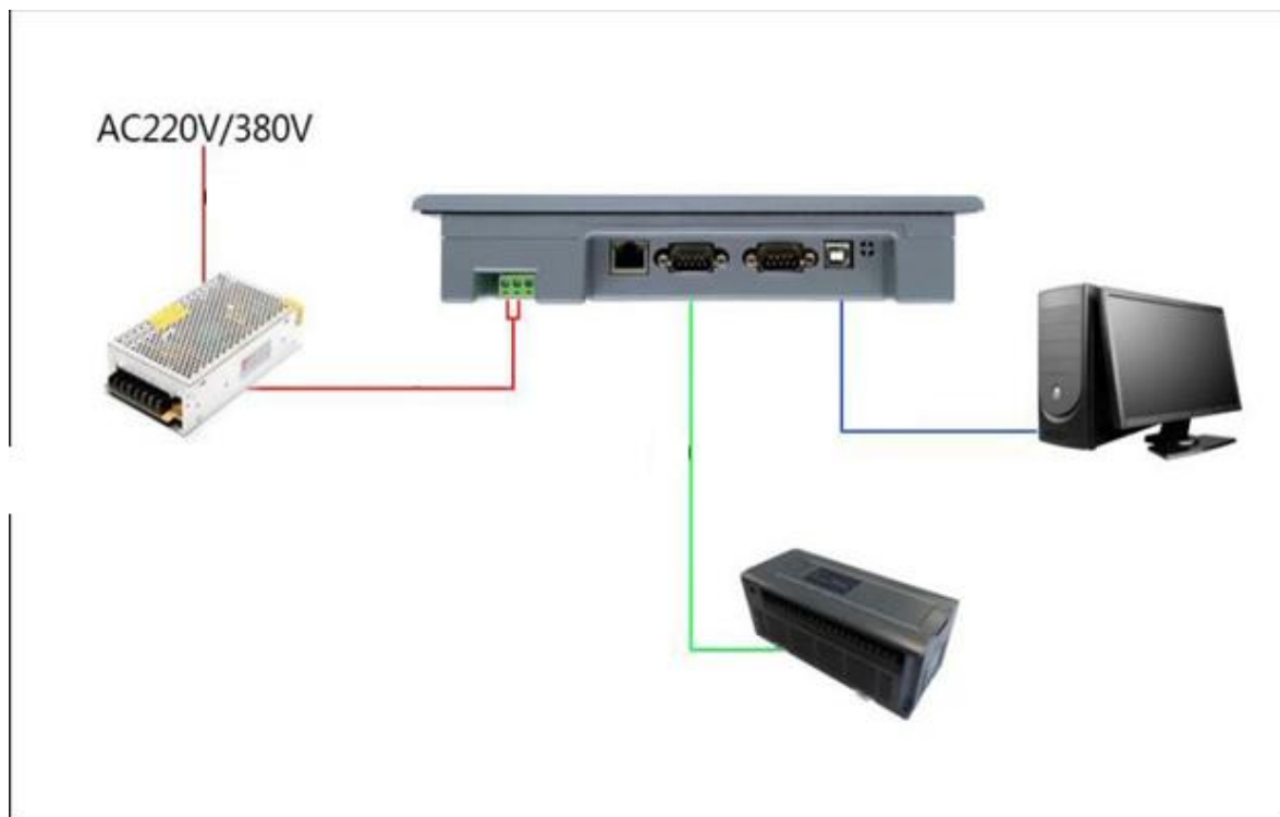
Рисунок 1-14 Подключение сенсорного экрана к ПЛК и ПК
