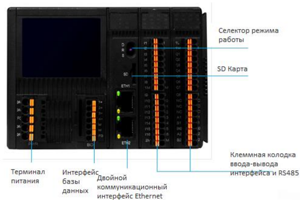
Рисунок 2-2-1 Схема внешнего аппаратного интерфейса модуля ЦП СК-1000 -ПЛК
