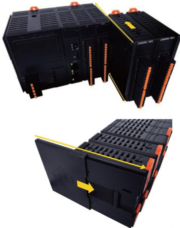
Рисунок 7-4-6 Установка модуля на рейку
