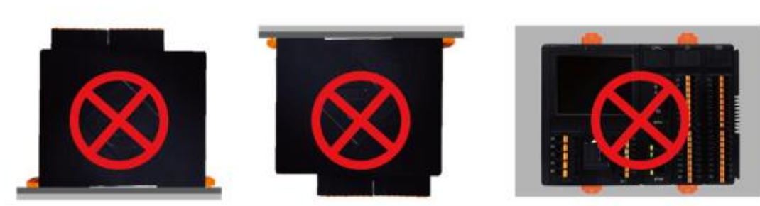
Рисунок 7-4-2 Методы установки, которых следует избегать
